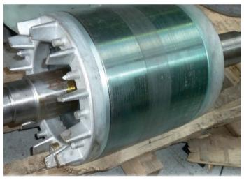
2. Die Cast Aluminium Rotor.
